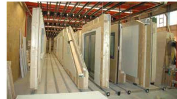
Vorgefertigte Elemente in Holzrahmenbauweise
